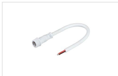
Артикул 032851 Круглый герметичный разъем 2pin MAMA с резьбовым креплением для подключения питания герметичных одноцветных светодиодных лент. Корпус IP65. Провод 20AWG (0.5 мм2), длина 15 см.
